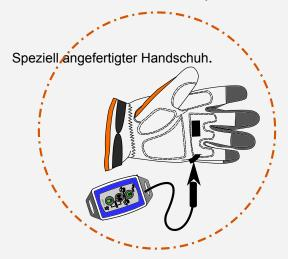
Der Sensor und die Analyseienheit sind auf einem speziell entworfenen Handschuh montiert. Der Sensort ist in einer angefertigten Tasche in der Handflläche montiert. Gemäß Standard ISO-5349.
