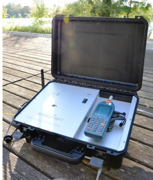
Das Messsystem wird einfach in Betrieb genommen. Messsystem mit wetterfestem Mikrofon kalibrieren und starten. Schon nach einer Minute können auf jedem PC, im Intranet, die Messdaten abgerufen werden.
