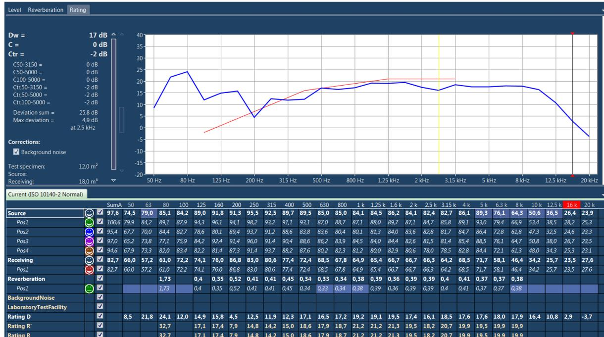
Alternativ können Sie festlegen, dass der Nor850 nach einer akzeptierten Messung das Rating-Fenster automatisch öffnet. Die Option „Show ratings after acceptance“ befindet sich im Menü „Nor850 options“, das durch Klick auf das Norsonic-Logo in der linken oberen Ecke aufgerufen wird.
