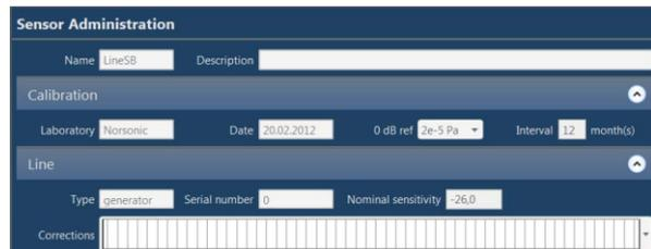
Das Line Sensor-Menü unterscheidet sich kaum vom Mikrophon-Menü mit Ausnahme der geprüften Empfindlichkeit, Polarisationsspannung und Vorverstärker, die bei Line nicht benötigt werden.
