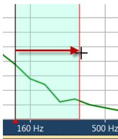
Dann Klicken Sie mit der rechten Maustaste auf das Spektrum, markieren „Set selected as single frequency“ und starten mit Accept die Messung. Der Nor850 führt nun automatisch eine normgerechte Messung der ausgewählten Frequenzbänder durch. Während der Messung wird der SPL in allen Frequenzen angezeigt.
