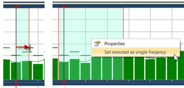
Dann klicken Sie mit der rechten Maustaste auf das Spektrum, markieren „Set selected as single frequency“ und starten mit Accept die Messung. Der Nor850 führt nun automatisch eine normgerechte Messung der ausgewählten Frequenzbänder durch. Während der Messung wird der SPL,  $L_{max}$  und  $L_{eq}$  für die jeweilige Frequenz angezeigt.
