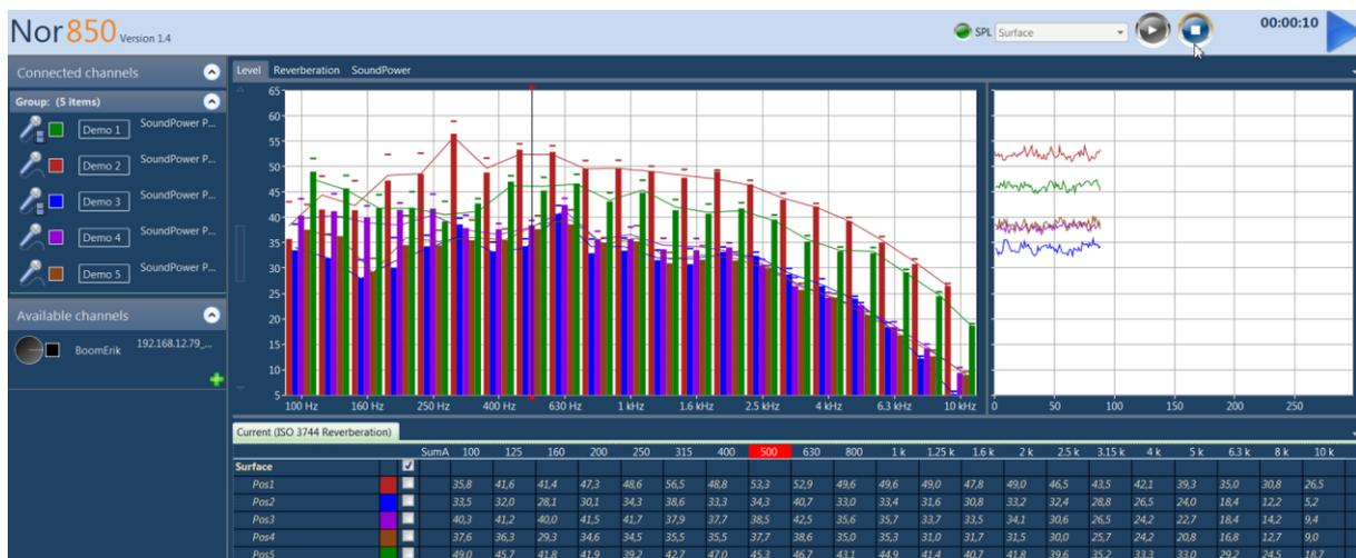
Wurde die vordefinierte Messdauer erreicht oder wurde Stop gedrückt, dann wird oben rechts das letzte gemessene Spektrum (dicke Linien) gemeinsam mit den möglichen vorhergehenden Mikrofonpositionen angezeigt. Zusätzlich zeigt eine dicke schwarze Linie den Mittelwert der vorangegangenen Messpositionen an. Links
